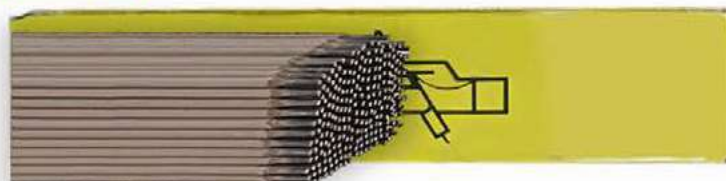
Eléctrodo de duplo revestimento que se caracteriza por um arco estável e concentrado. Apropriado para passos de raiz e soldadura em posição. Excelente resistência à fissuração. Escória de fácil eliminação.
