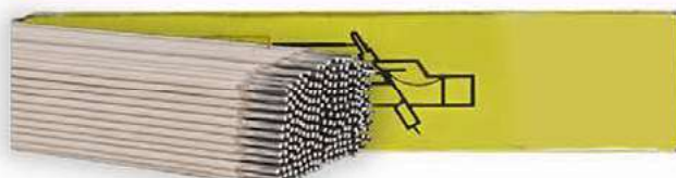
Eléctrodo com adição de liga Cr-Mo-V. Depósito com uma elevada resistência à pressão e à abrasão e resistência ao impacto. Resiste a temperaturas de até 550°C. Utilizado em dentes de baldes, ferramentas de compressão a frio, cones trituradores, lâminas de corte.
